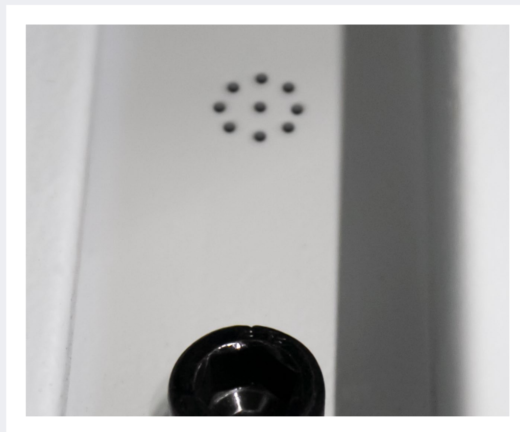
8 BURACOS PARA CONDENSAÇÃO DA ÁGUA
